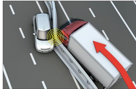
**Auslenkung bei flexiblem Betonsystem: 1,3 m**
